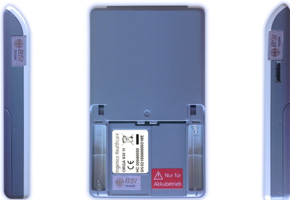
Abbildung 4: Positionen der drei Gehäusesiegel am Gehäuse des Gerätes
